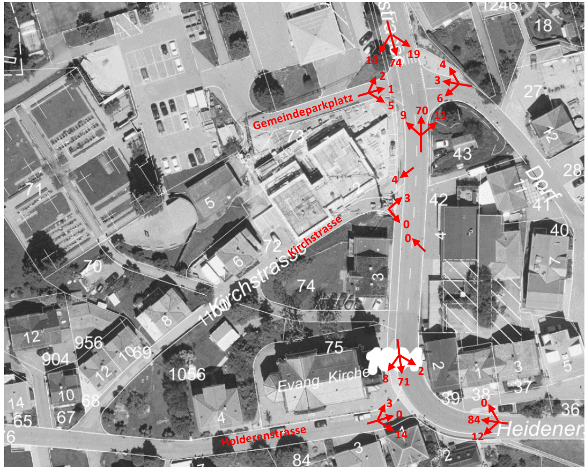
Abbildung 3: Verkehrsfrequenzen im Betrachtungsperimeter, Abendspitzenstunde in FZ/h
